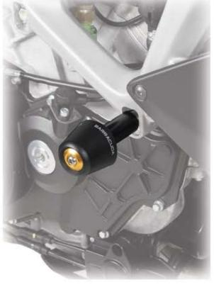
BEFORE START IN THE MOUTING PROCESS, FIND THE FIXING POINT ON THE MOTORBIKE.
